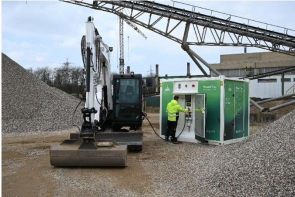
Bildunterschrift: Am PowerTree kann der E-Bagger innerhalb kurzer Zeit aufgeladen werden.
